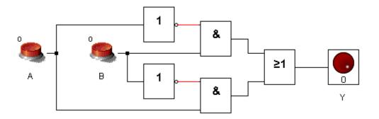
2) Stellen Sie eine Hypothese über das Schaltzeichen eines Gatters auf, das die gegebene Wertebelegung hat. Prüfen Sie die Hypothese im Simulator in einer neuen Schaltung. Geben Sie den Namen und das Schaltsymbol des Gatters an.
